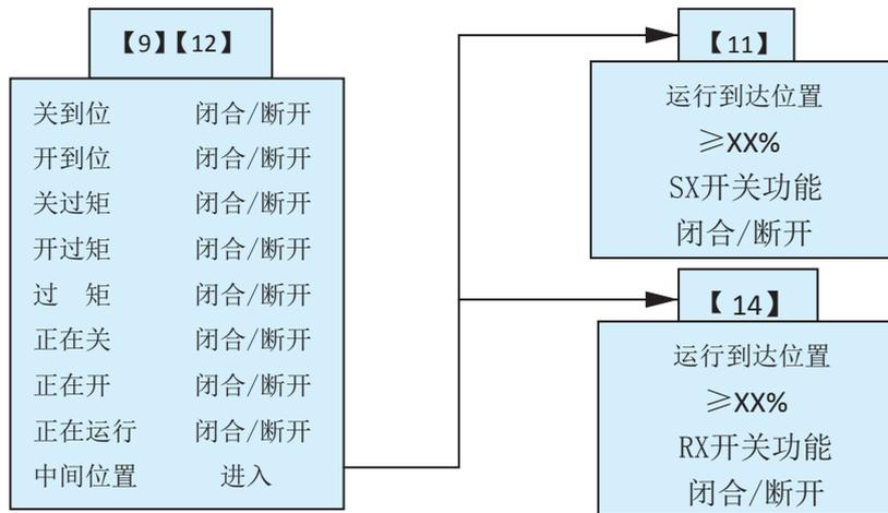
在【8】号菜单中，用“上移键”或“下移键”选中“标配触点”项并按“确认键”后屏幕显示【10】号菜单的内容。
