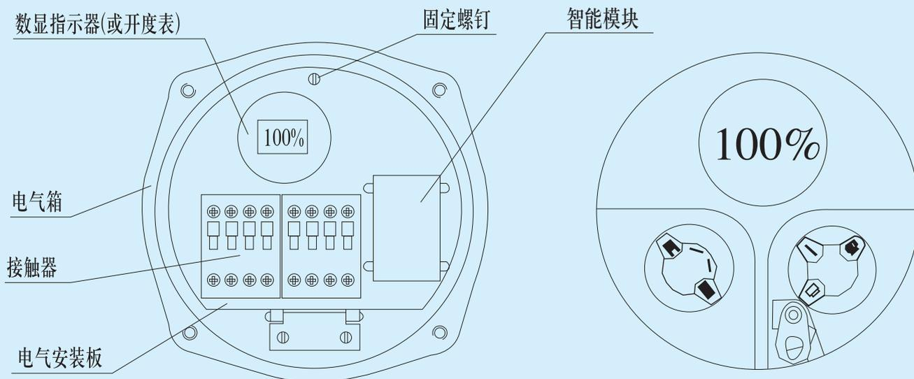
图6 智能型和调节型电气部分结构
