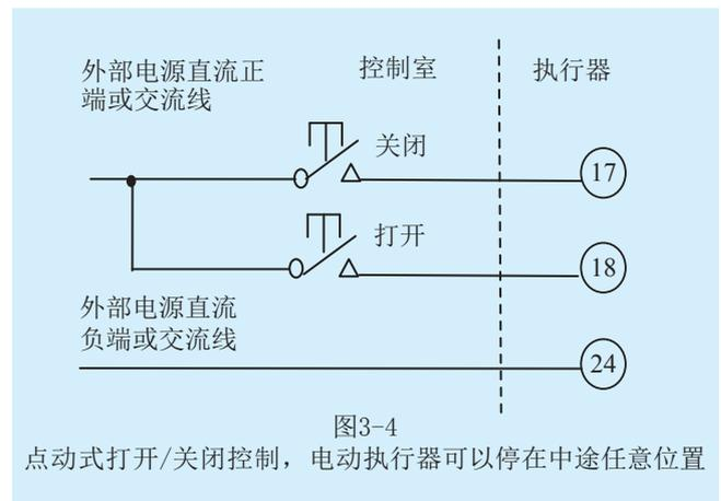
若使用外部24V直流电压或220V交流电压实现三线控制，外部连线见如图3-4、图3-5、图3-6所示。
